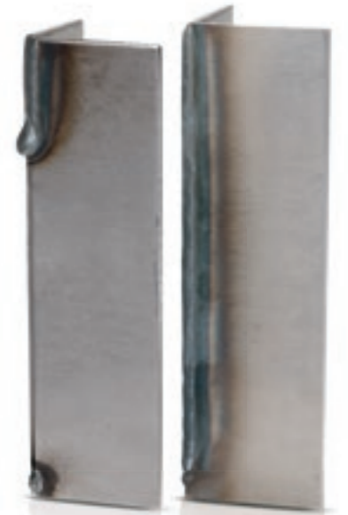
Eine geschweißte Ecknaht im Vergleich. Standard-Lichtbogen (links): Sehr schnell vorlaufendes Schmelzbad, kurz vor dem Herunterfallen. SpeedCold (rechts): Komplet, sicher und schnell geschweißt (35 cm/min).
