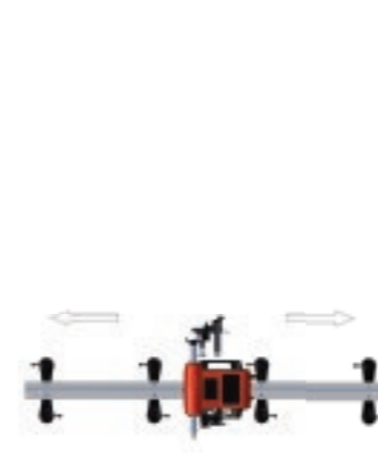
in horizontaler Position mit Führungsschiene (seitlich mit Magnethaltern)
