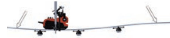
auf einer gewölbten Ebene mit Flex-Führungsschiene
